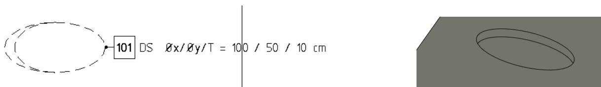
Bild 24: Darstellung eines Deckenschlitzes inkl. Beschriftung
