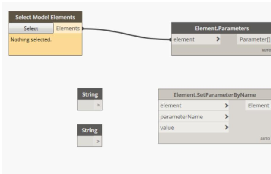
In Revit sollte man sich in einer Ansicht befinden, in der alle Stützen zu sehen sind. Durch klicken auf Select des Select Model Elements Blocks, wird zunächst eine Stütze markiert (durch gedrückt halten der linken Maustaste ein Markierungsfenster aufziehen).
