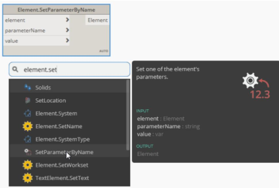
Das nächste Ziel ist es eine Textverkettung aus zwei unterschiedlichen Parametern zu erzeugen und diesen Wert in einen neuen Parameter zu bündeln. Dabei werden die Parameter „Brandschutzanforderung“ und „Tragendes Material“ durch folgenden Ausdruck „:“ kombiniert und in den Parameter Kennzeichen ausgegeben.
