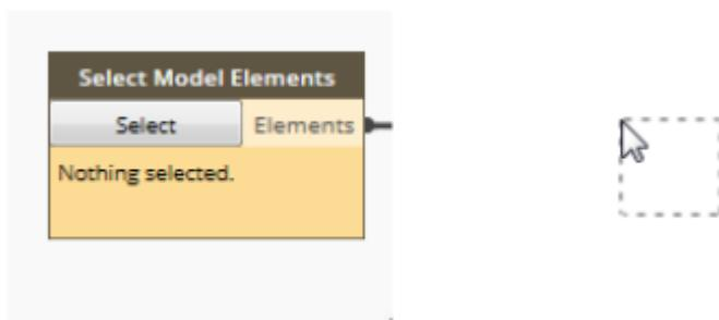
3. Den Rechenprozess des Blocks Select Model Elements „freeze“n. So werden alle nachfolgenden Blöcke auch für die nächsten Durchläufe gesperrt.
