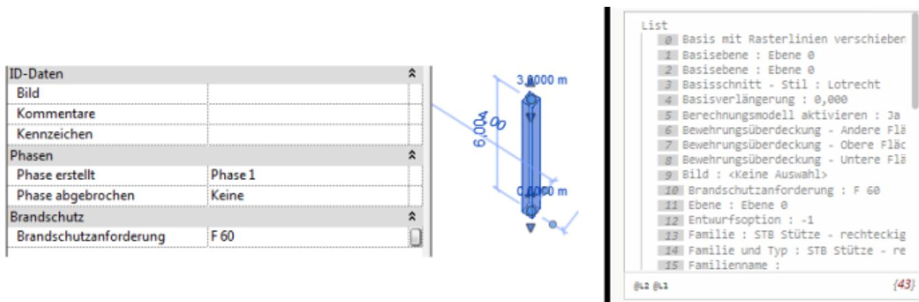
Jetzt werden alle Stützen markiert und mit der Feuerwiderstandsklasse F 60 überschrieben. Es ist darauf zu achten, dass bei der Auswahl auch nur die überschriebenen Elemente ausgewählt werden. Hier empfiehlt sich die 3D-Ansicht. Sie blendet die Rasterlinien nicht mit ein und eignet sich daher für den Auswahlmodus.
