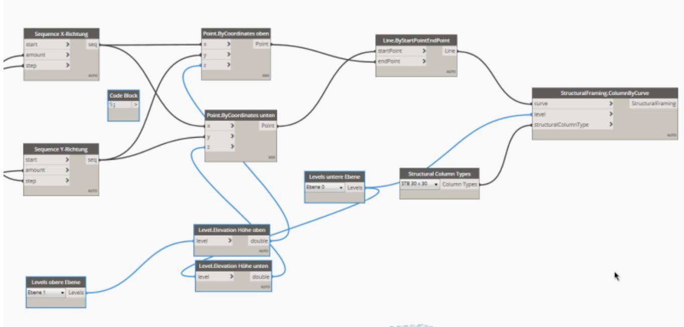
Es ist außerdem zu sehen, dass der Code Block nicht mehr mit dem „z“-Anschluss verbunden ist. Eingänge können jeweils immer nur durch einen Draht verbunden werden. Wird ein Draht durch einen anderen überschrieben, löst sich die Verbindung automatisch. Es ist jedoch möglich mehrere Ausgänge für unterschiedliche Eingänge zu definieren (siehe Block „Levels untere Ebene“). Der Code Block mit dem Wert 5 kann gelöscht werden.
