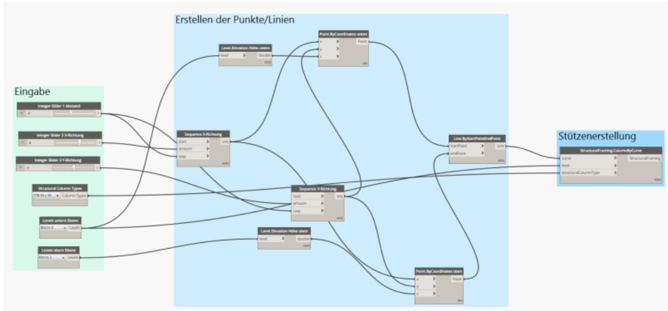
Um eine anschauliche Struktur der Blöcke zu erzielen, kann man diese automatisch sortieren lassen. Dafür werden alle Blöcke markiert und durch Tastenkombination Ctrl + L strukturiert.
