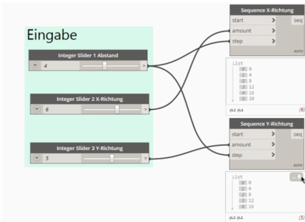
Hält man den Mauszeiger über die Schrift „Auto“ im Block, öffnet sich ein zusätzliches Fenster. Durch klicken der Pinnadel erhält man dauerhaften Einblick in den aktuellen Dateninhalt des Blocks. Des Weiteren werden die Blocknamen mit zusätzlichen Informationen gefüllt, um sie zu einem späteren Zeitpunkt besser zu verstehen.
