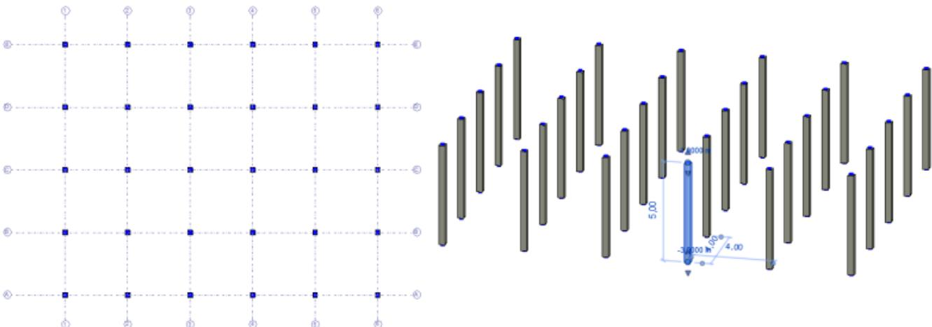
Der aktuelle Zwischenstand erstellt die Stützen in das vorgegebene Raster. Eine weitere Automatisierungsoption besteht darin, die Stützen immer zwischen zwei ausgewählten Ebenen zu generieren. So bekommen die Linien intelligente Höhenkoordinaten und sind dadurch im Bezug zu den Ebenen performant. Dies wird nachfolgend genauer erklärt.
