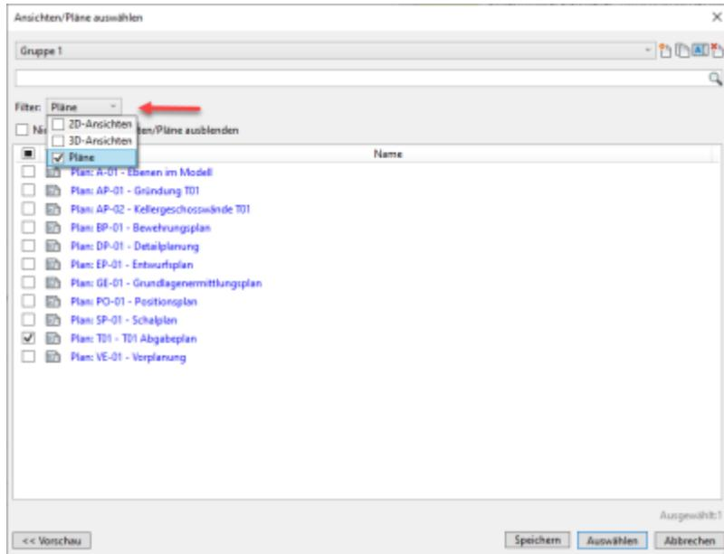
Die Elemente welche als PDF-Datei exportiert werden sollen sind in einem Unterdialog zu wählen. Der Dialog wird über das *Bleistift-Symbol* erreicht. Im Bereich *Filter* kann die Anzahl der angezeigten Elemente verringert werden. Die gewünschten Elemente sind auszuwählen und der Dialog per *Speichern* und *Anwenden* zu verlassen.
