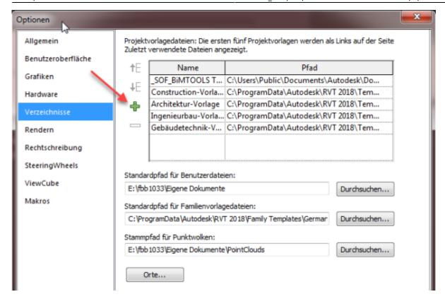
Mittels dem *Plus-Symbol* können Templates himzugefügt werden. Das benötigte SOFiSTiK Template befindet sich hier
