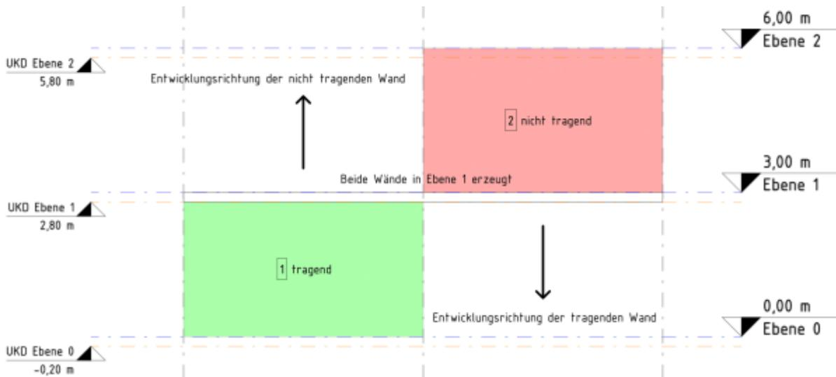
Über Einstellungen in den Ansichtsvorlagen werden diese von der aktuellen Ebene aufgehenden Bauteile ausgeblendet. Es wird ein Hinweis ausgegeben. Die Nichttragenden Wände werden erst sichtbar wenn eine Ebene aktiviert wird die diese Elemente enthält.
