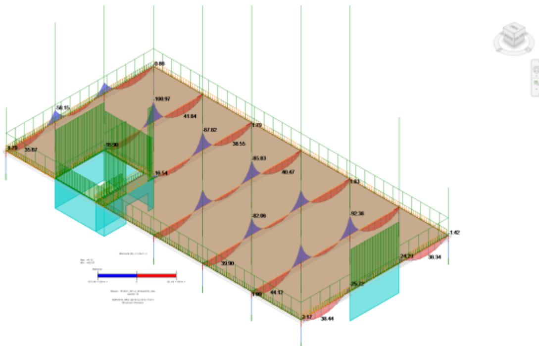
Soweit auch Bemessungsergebnisse vorliegen können diese ebenfalls importiert und visualisiert werden. Hierzu kann im Ergebnis Explorer mittels Berechnung der Ergebnissatz gewechselt werden. Die Darstellung kann analog der Schnittgrößen eingestellt werden. Siehe hierzu auch [Bewehrung erzeugen und prüfen](#)
