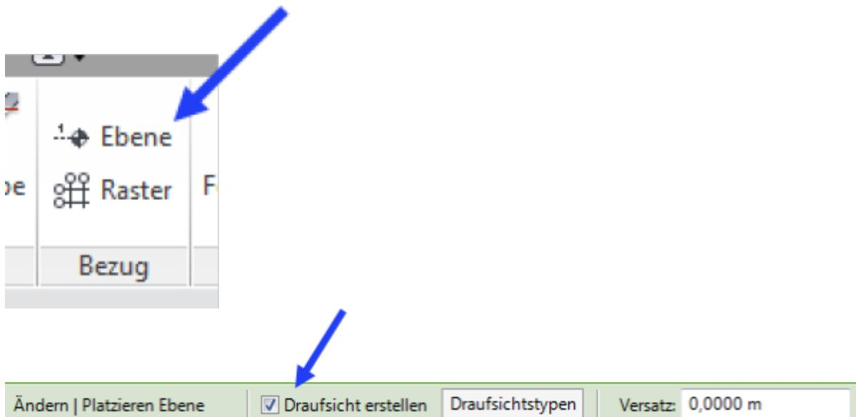
In der gewählten Ansicht werden die Achsen vertikal angezeigt. Horizontal sieht man die Ebenen. In **blau**  $\Rightarrow$  **Ebene [Nr]** vom Typ Ebene OKD. In **orange**  $\Rightarrow$  **Ebene [Nr]** vom Typ Ebene UKD. Die Abstände werden nach Auswahl einer Ebene durch ändern der Maßzahl angepasst. Eine neue Ebene wird analog einer Achse jedoch mit dem nunmehr aktiven Werkzeug
