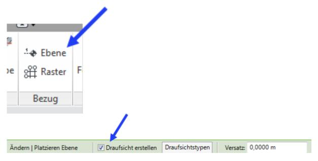
In der gewählten Ansicht werden die Achsen vertikal angezeigt. Horizontal sieht man die Ebenen. In blau ⇒ Ebene [Nr] vom Typ Ebene OKD. In orange ⇒ Ebene [Nr] vom Typ Ebene UKD. Die Abstände werden nach Auswahl einer Ebene durch ändern der Maßzahl angepasst. Eine neue Ebene wird analog einer Achse jedoch mit dem nunmehr aktiven Werkzeug
