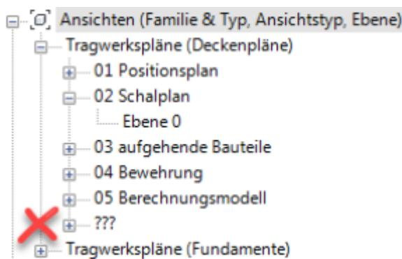
Die neue Ebene wird unterhalb von Ansichten in einer neuen Plankategorie **???** erzeugt. Die Namen der neuen Ebenen sollten dem vom Anwender gewählten Schema entsprechend umbenannt werden und ggf. die Höhenlage angepasst werden. Eine notwendige Ansicht kann später erzeugt und den Plänen zugeordnet werden.
