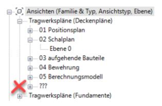
Die neue Ebene wird unterhalb von Ansichten in einer neuen Plankategorie ??? erzeugt. Die Namen der neuen Ebenen sollten dem vom Anwender gewählten Schema entsprechend umbenannt werden und ggf. die Höhenlage angepasst werden. Eine notwendige Ansicht kann später erzeugt und den Plänen zugeordnet werden.
